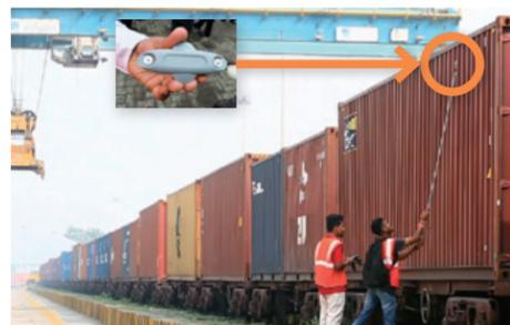
コンテナに磁石で簡単に取り付けられるRFID
