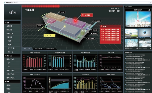
「環境経営ダッシュボード」は、電力使用量データをリアルタイムで集約し、経営の効率化とCO2削減に貢献する
