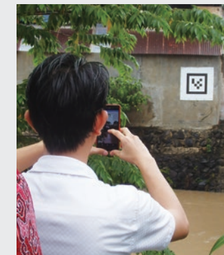
インドネシア、北スラウェシ州マナド市でのスマートフォンとAR技術を活用した河川水位測定
