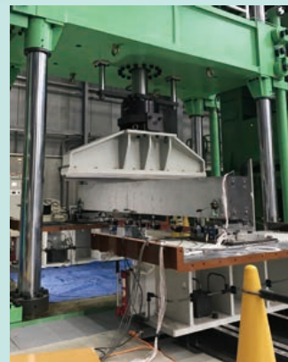
RC梁試験体を用いた疲労载荷試験
