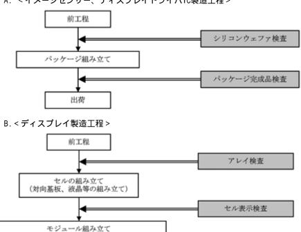
当社の半導体検査装置は上記A.の工程に導入され、ウエーハ検査並びにパッケージ検査の両方で使われています。 また当社の親会社となる武漢精測電子集団股份有限公司の検査装置は、主にB.のモジュール表示検査工程で使われています。
