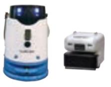
レーザーと超音波センサーで周囲の障害物を正確に検知しながら、自動運転で床を清掃
