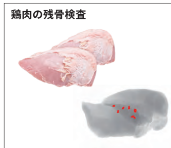
異物検査 食品などに含まれる石やプラスチック、残骨などを検出します。
