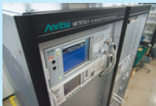
LTE-Advanced コンFORMANCEテストシステム (LTE-Advanced端末が国際標準規格に適合していることを検証するためのテストシステム)
