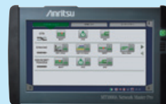
トランスポータテスタ (1台でネットワークを構成する各種通信システムの評価を可能とする測定器)
