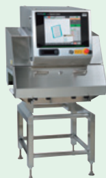
X線異物検出機 (食品の生産ラインで粉れ込む金属や石、プラスチックなどの異物検出が可能)
