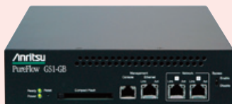
帯域制御装置 (通信事業者や金融機関などの高品質なIPネットワークの運用を支援)
