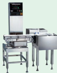
重量選別機 (食品・薬品の生産ラインで使用され、内容量が適正かどうかを検査する選別機)
