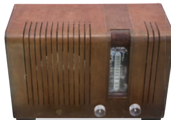
スーパーヘテロダイン方式ラジオ フェライトコアを使用することによりきれいな音を実現した この方式の普及が、TDKの「文化、産業への貢献」の大きな契機になりました。
