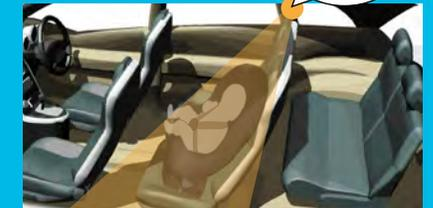
レーダ方式は大きく分けて、FMCW\*とパルスの2種類がありますが、パルスコヒーレント方式の特長を活かした製品を作りたいと考え、小型、軽量で車両の狭い場所にも設置可能というコンセプトの下に本製品を開発しました。今後は子供置き去り検知以外の機能を追加したバラエティ製品の開発も行い、社会の安心、安全に貢献していきたいと思えます。
