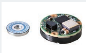
セラミックパッケージ型全固体電池 を内蔵した多回転アブソリュートエン コーダ「MAR-M700MFA」
