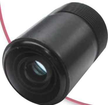
非球面プラスチックレンズを採用することで、小型・軽量、高解像度を実現するとともに、独自の耐熱AR※技術を開発し、耐熱樹脂と組み合わせることで優れた耐熱性能も併せ持つ高性能な車載用カメラレンズユニットです。主に、水平画角30°~80°の狭角レンズユニットは前方センシング用途、また水平画角120°~210°の超広角レンズユニットが後方、サイド、全周囲視用途で使われています。
