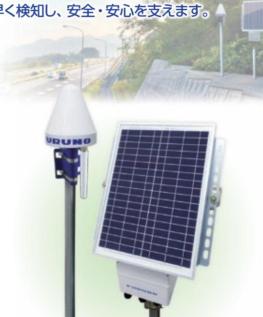
GNSS自動変位計測システム DANA (ダーナ)\*
