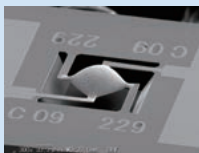
MEMSガスセンサ センサ素子は0.1mm四方で、体積1/500、 消費電力1/600(当社従来比)を実現
