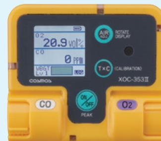
この度開発した酸素・一酸化炭素計「XOC-353II」は、酸素、一酸化炭素の2ガス同時検知が可能な小型・装着型のガス検知器で、お客様の使い勝手を考慮し、カラー液晶表示や表示反転機能を搭載。また、NFCによるログデータ収集セット(オプション)や熱中症対策に役立つ暑さ指数(WBGT値)表示を搭載しました\*。アルカリ乾電池1本で約5,000時間の連続使用が可能。COセンサは寿命が2年なので、センサ交換の手間やコストが軽減されます。
