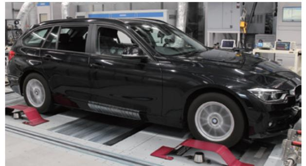
試験室で路上走行試験を再現する様子
