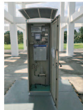
クアラルンプール市に採用された自動水質測定装置
