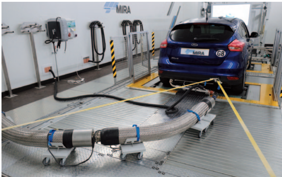
開設した先進的排ガス試験設備
