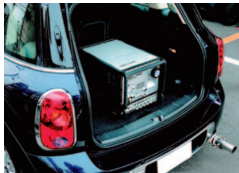
車載型排ガス測定装置「OBS-ONE」
