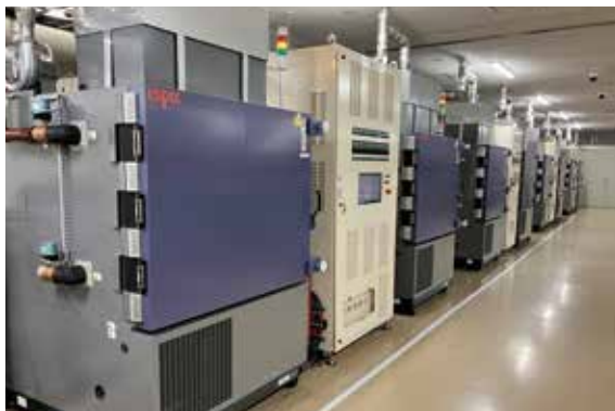
バッテリー安全認証センターにて車載用バッテリーの充放電試験や釘刺し試験の設備を増強(宇都宮テクノコンプレックス内)
