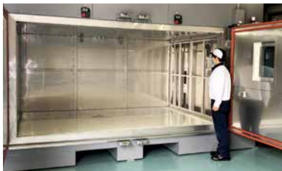
国連規則に定められた車載用バッテリーの安全性試験を行う 大型温度サイクル試験装置
