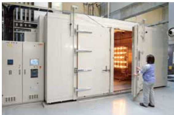
SAITECに納入した人工気象室 灼熱の砂漠、亜熱帯、寒冷地などあらゆる環境が再現でき、実際に使用される気象環境下で製品の信頼性評価を行います
