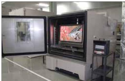
電子機器・部品などを試験する恒温恒湿器
