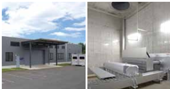
バッテリー安全認証センター (エナジーデバイス環境試験所内) 車載用二次電池の圧壊試験装置
