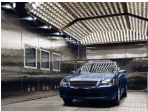
自動車が入る大型の環境試験装置
