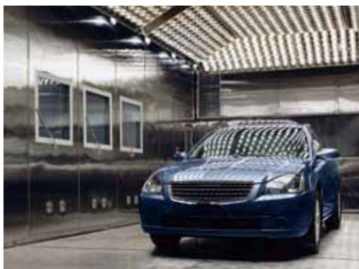
自動車が1台入る大型の環境試験装置
