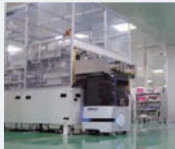
自動搬送システム
