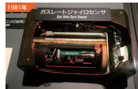
ガスレートジャイロセンサ 世界初の自動車用地図型ナビゲーションシステムに採用
