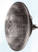
1957年 完全密封式メタルバック・シールドビーム 「自動車産業におけるスタンレーブランドを確立した製品」
