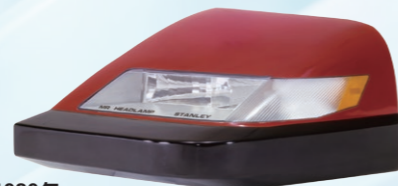
1989年 MR (マルチリフレクター)ヘッドランプ 「カーデザインの自由度を高めた、世界初レンズカットの無いヘッドランプ」
