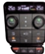
ヒーター コントロールパネル
