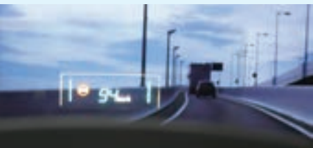
HUD(ヘッドアップディスプレイ)用パッシブ駆動カラーLCDモジュール
