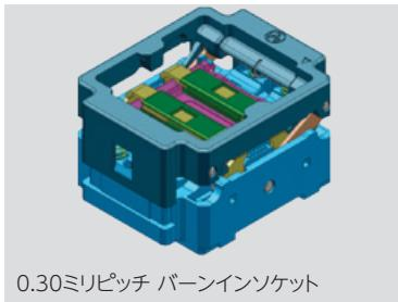
近年モバイル機器は、ディスプレイの大型化、画面解像度や通信機能の向上は目覚ましく、これを支える半導体も演算能力の高速化や電力効率の向上化がますます進み、機器への実装効率を上げるため半導体の外部接続部分は更に微細なピッチが要求されています。当社は、蓄積した独自の技術で、一度に沢山の半導体をテストすることを考慮した大変コンパクトな0.30ミリピッチバーンインソケットを開発、ラインアップしました。今後お客様のニーズにお応えする基礎技術に取り組み、最適なテストソリューションを提供してまいります。
