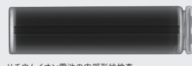
リチウムイオン電池の内部形状検査
