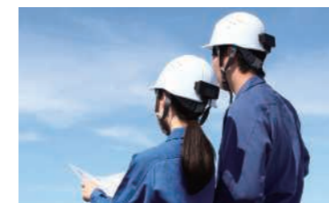
作業安全モニタリングシステム ヘルメットに装着可能なセンサデバイスを用い作業中の安全を"見える化"
