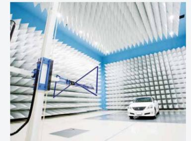
盗難からクルマを守るため、日々セキュリティ対策を進化させています。国内最大級の電波暗室でのEMC(Electro-Magnetic Compatibility)評価と卓越した解析力で高度な製品開発を支えています。
