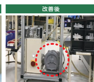
ラインごとに小型集塵機を分散配置
