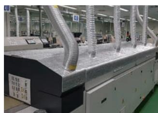
リフロー炉の断熱化
