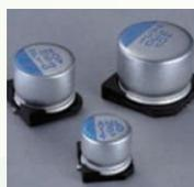
導電性高分子アルミ固体電解コンデンサを発表 (1998年)
