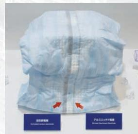
縦に黒く見える2本の線が、紙おむつ内部に仕込まれた電極。右側がアルミニウムエッチド箔、左側が活性炭。着用時の違和感をなくすため、電極は非常に薄く、しなやかに作られています。
