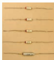
トランジスタラジオのファーストモデルに採用された、超小型電解コンデンサ (1955年製)
