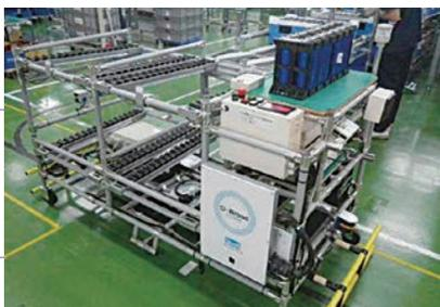
日本ケミコングループのケミコン長岡株式会社で稼働中のキャパシタ式ワイヤレス給電無人搬送車。手前に見える白いプレートがワイヤレス給電のための受電コイルユニット。この台車を使って部品を製造ラインまで自動搬送している。
