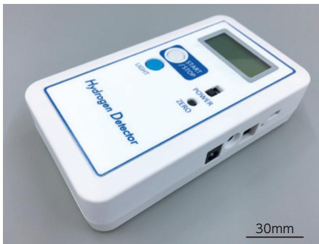
水素ガス漏れ検知器（NEDO事業試作機）
