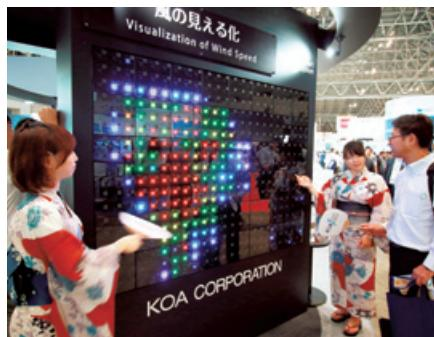
従来の“風の見える化”パネルは個々のセンサが独立して動作していましたが、今年は432個搭載されている風センサの情報をパソコンで収集して処理し、その情報に応じた映像を投影することによりさまざまな演出ができるようになりました。それぞれの風力の情報をリアルタイムに表示させたり、風の情報から風を思わせる映像を表現させることができます。
