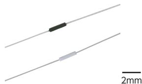
熱式流速センサは高温環境に対応し高精度の温度特性を持つヒーター素子が必要なことから、周囲温度の変化に対し抵抗値が素早く変化する熱応答性に優
