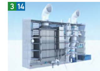
3 14 船舶用排ガス浄化装置
