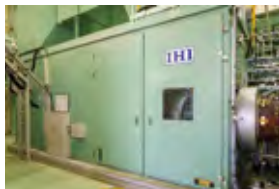
2,000kW級アンモニア混焼ガスタービン
