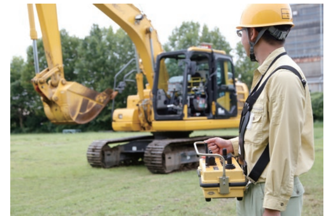
バックホウに装着した「ロボQS」（簡易遠隔操縦装置）
