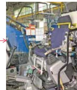
無人機システムの実用的な取り組みの先駆けとして、2017年に国土交通省九州地方整備局九州技術事務所および株式会社フジタと共同で「ロボQS」を完成させました。バックホウと呼ばれる作業用ショベルカーの操縦席に取り付けることで、無線機による遠隔操作を可能にする装置です。危険な災害現場において、安全で迅速な復旧作業に役立っています。
