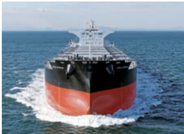
117千重量トン型ハンディーケープ・バルクキャリアー (サノヤス造船㈱)
