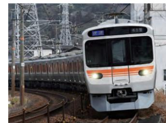
ある平滑かつ強度向上を図った構体、日車オリジナルの「NS台車」、台車等の異常を早期に検知する状態監視技術が採用されています。
