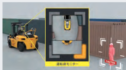
大型フォークリフト用AI人検知システム「グッドファインダー」
