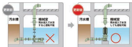
横軸陸上ポンプから縦軸槽外型(耐水型)ポンプへの更新例
