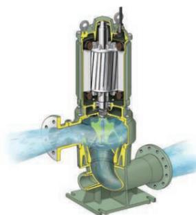
縦軸槽外型(耐水型)ポンプ(断面図)
