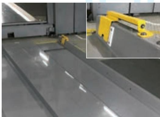
駐車設備側の充電コンセントにEVの充電ケーブルを差し込み、パレットが棚に格納されると充電を開始します。
