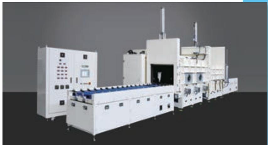
韓国真空の主力製品「車載用二次電池向け真空乾燥装置」
